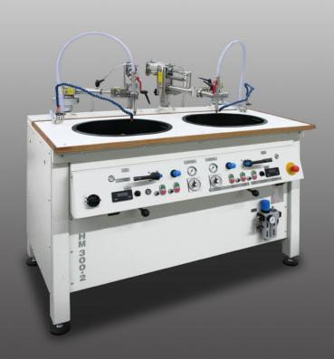
Традиционный, высокоэффективный притирочный и полировальный станок для обработки оптических деталей.
